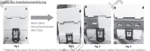
\* Wählen Sie eine 35-mm-Standard-Din-Schiene (die Länge wird von Ihnen selbst bestätigt) und befestigen Sie sie an der Stelle, die auf die Installation wartet.
